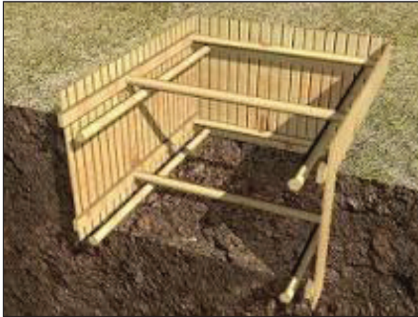
Exemple de boisage d'une fouille
